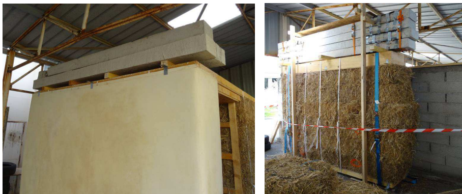
Figure 5. Chargement de murs en paille porteuse pour essai de fluage sur mur brut et enduit.
